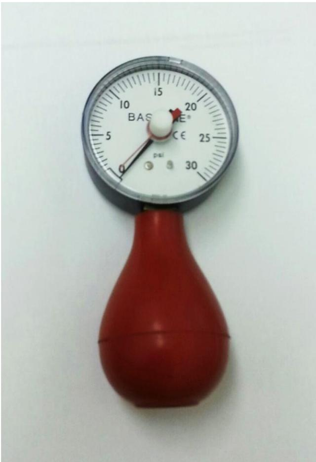
Figure 1. Baseline<sup>®</sup> Pneumatic Squeeze Bulb Dynamometer (NC 70122).
